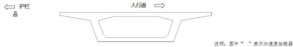
图 3 J1、J2 截面动力试验测点布置图
